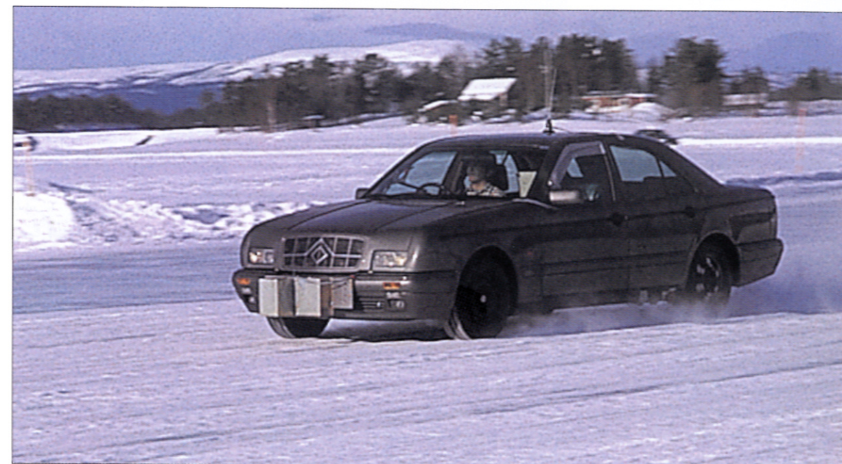
Das elektronisch geregelte Traktionssystem ETS wirkt beim Anfahren auf Fahrbahnen mit unterschiedlichen Griffigkeiten durch Abbremsen eines Rades wie eine Differentialsperre.
