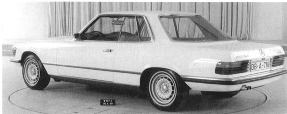
Utkast til coupé-karosseri fra 30.04.69. I denne versjonen er blendene på bakre sidevindu på plass. Denne løsningen var det Karl Wilfert som kom opp med fordi den korte avstanden mellom døren og hjulbuen bak gjorde det var vanskelig å konstruere en heve- og senkemekanisme for et sidevindu i full lengde.
