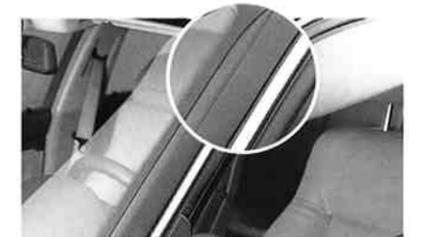
▲ Die Schmutzleiste beim Flaggschiff der Bayern, aufgesteckt und angeklebt.
