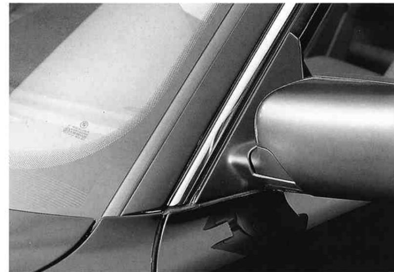
▲ Die Übergänge an der A-Säule des BMW, eine Preiswert-Lösung, Plastikteile sind angeklebt und angesetzt.
