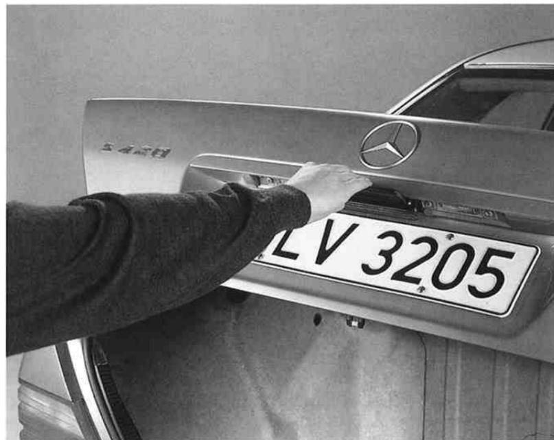
▲ Die Griffleiste zum Schließen des Heckdeckels fährt bei Bedarf automatisch aus. Daher kein Kontakt mit der Lackierung – kein Verschmutzen.
