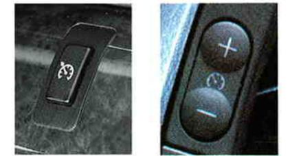
▲ Der Tempomat am Lenkrad ist nur aktiv, wenn der „Hauptschalter“ in der Armaturentafel eingeschaltet wurde.
