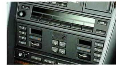
▲ Um die Flut der Tasten wieder einzudämmen, bedient sich BMW eines Tricks: Ein Teil der Bedienelemente für das Radio verschwindet hinter einer Blende.
