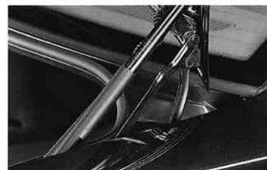
▲ Sehr umständlich gelöst: die Halterung des Kofferraumdeckels im neuen Siebener. Ecken und Kanten erschweren das Beladen.
