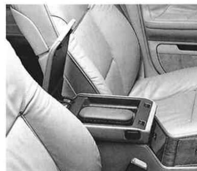
▲ Der zu enge Öffnungswinkel in den Fahrzeugen der Siebener Reihe. Darüber hinaus ist die Mittelkonsole zu hoch trotz der auf Wunsch lieferbaren Armauflage vorn verschiebbar – behindert sie den Fahrer in Fahrzeugen mit manuellem Getriebe beim Schalten.
