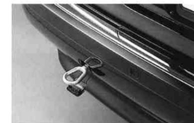
▲ BMW zeigt, wie man mit einem Abschlepphaken für ein Fahrzeug auskommt: Er wird bei Bedarf vorne oder hinten eingeschraubt.
