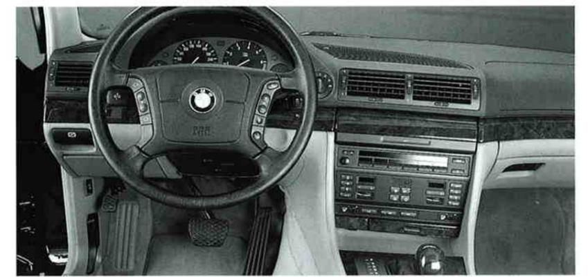
▲ Die Lichtdrehschalter sind zu klein, das Lenkrad verdeckt sie teilweise.
