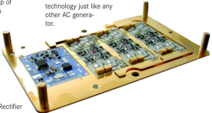
*FETs replace diodes in efficient active rectification circuits.*
