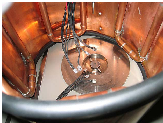
Fig 10-2 Termistorer plassert i kabinettet
